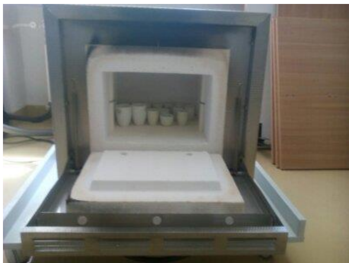
Slika 10. Prikaz sušenja ružinih latica u mufolnoj pećnici u svrhu određivanja pepela (Snimila: Ivana Filipović)
