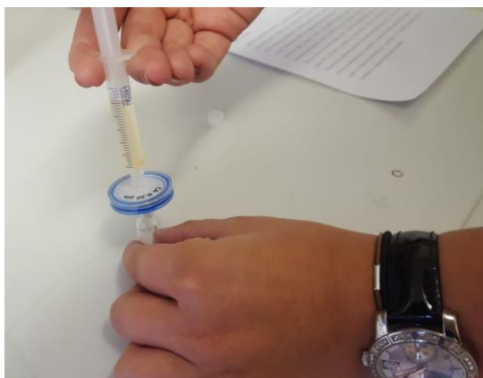
Slika 6.2.4. Dobivena otopina prije HPLC analize filtrirana je preko PTFE membranskog filtra
