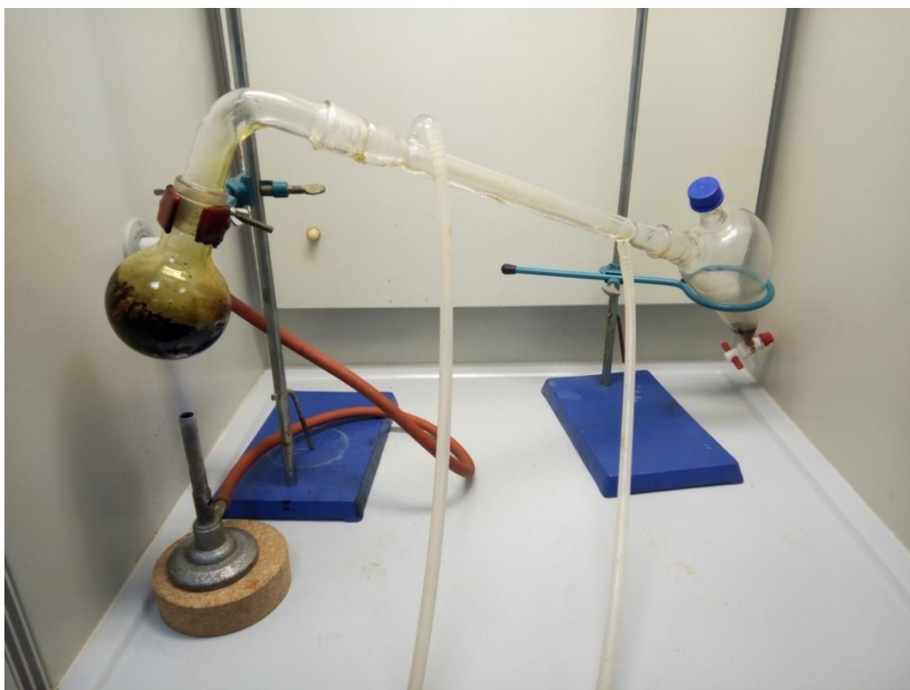
Slika 11. Proces pirolize koštica breskve, marelice i šljive unutar laboratorijskog digestora
