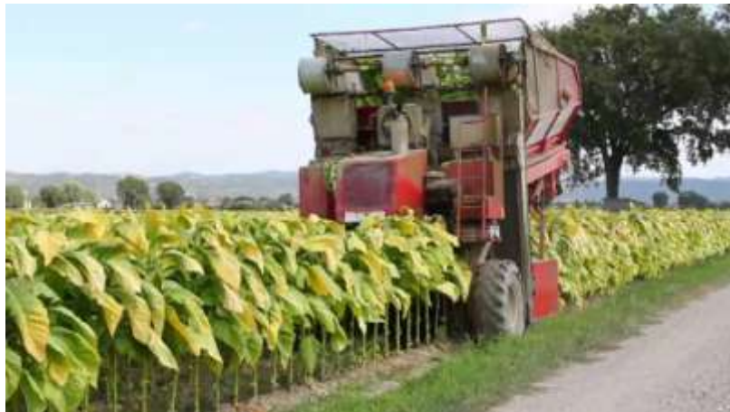
Slika 2.6. Strojna berba duhana (RA 632 model)
