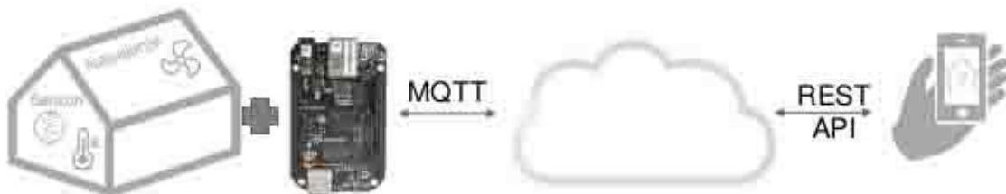
Slika 3.3 Način funkcioniranja sustava Zelene kuće<sup>4</sup>
