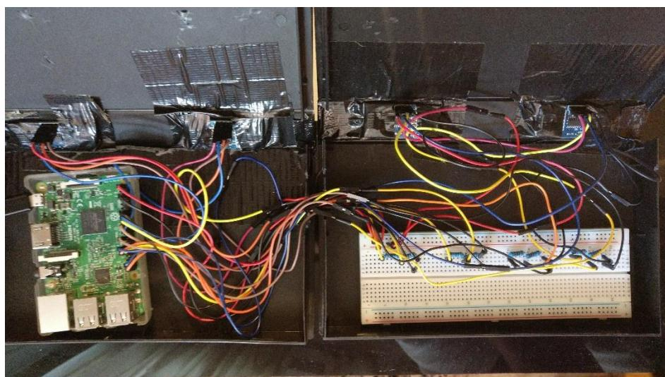
Slika 4.1 Spoj Raspberry Pi s ultrazvučnim senzorima
