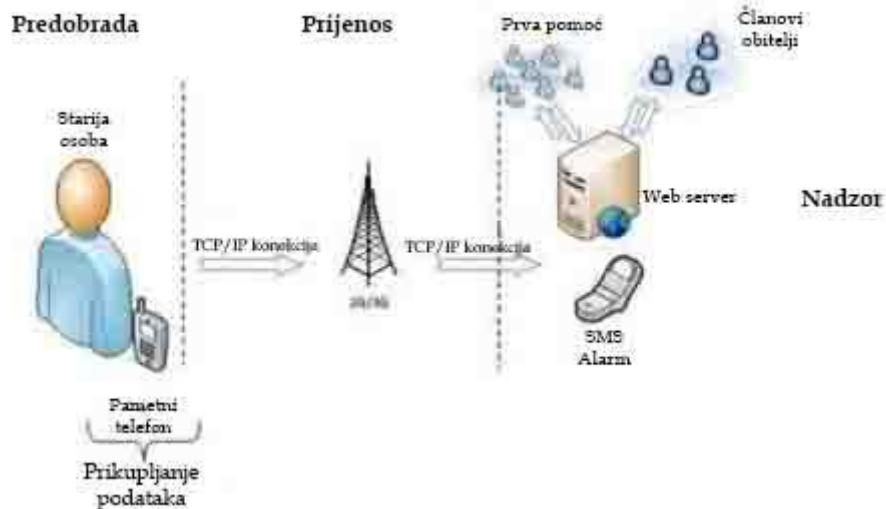
Slika 3.2 Način funkcioniranja sustava detekcije pada
