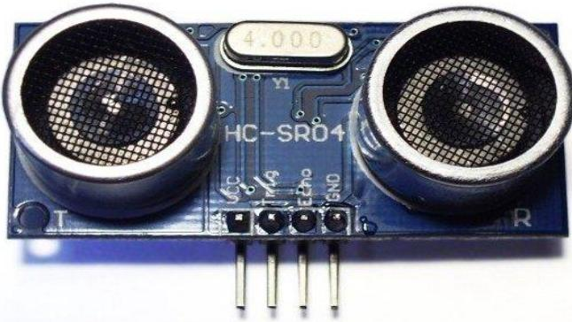
Slika 4.6 Ultrazvučni senzor
