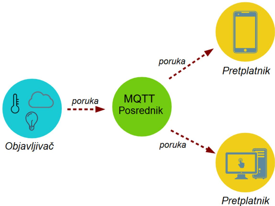
Slika 3.6 Prikaz komunikacije korištenjem MQTT protokola<sup>8</sup>
