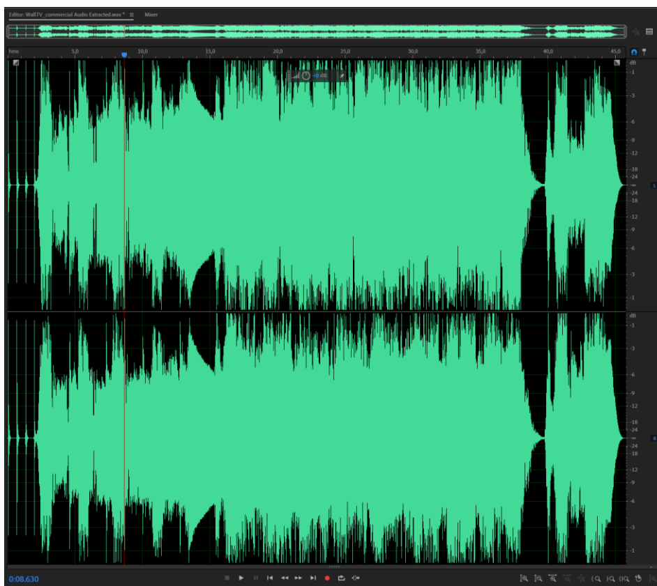
Slika 8.80 Prikaz zvučnog vala nakon Multiband kompresije
