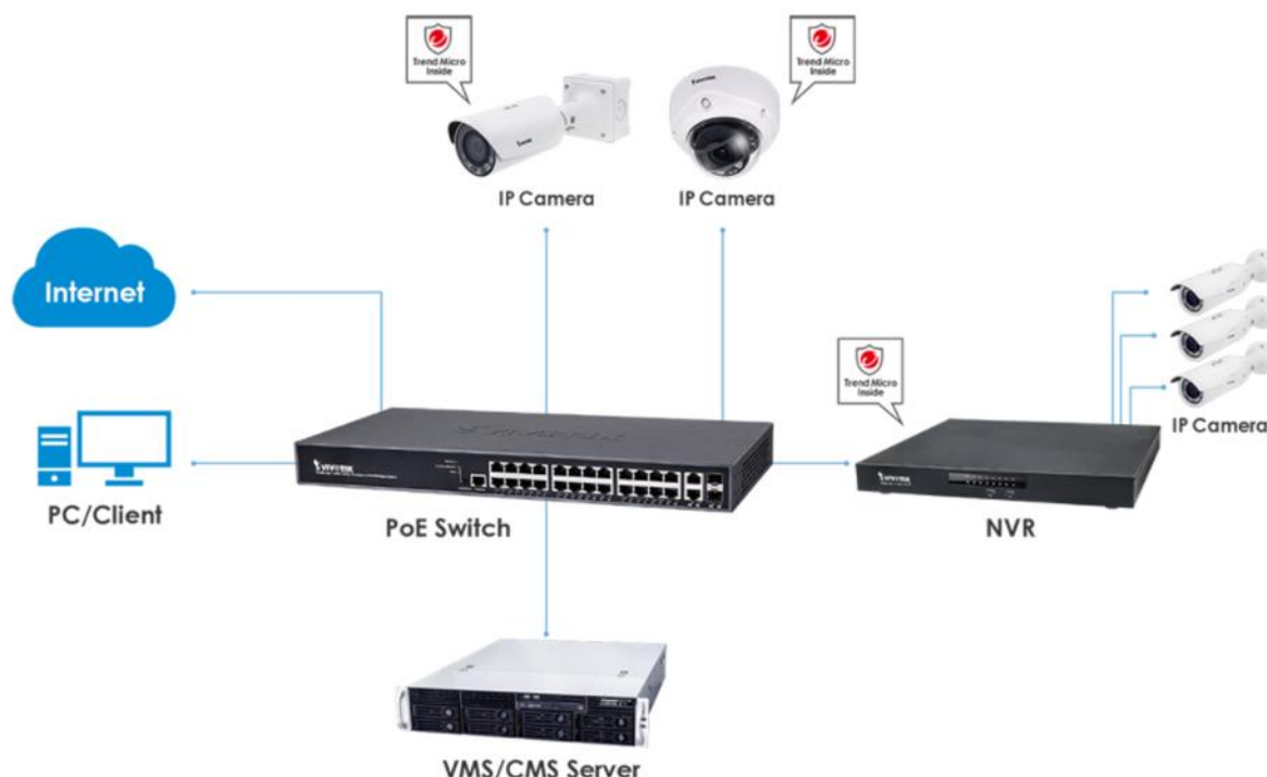
Slika 5-1 Primjer mrežnog sustava videonadzora
