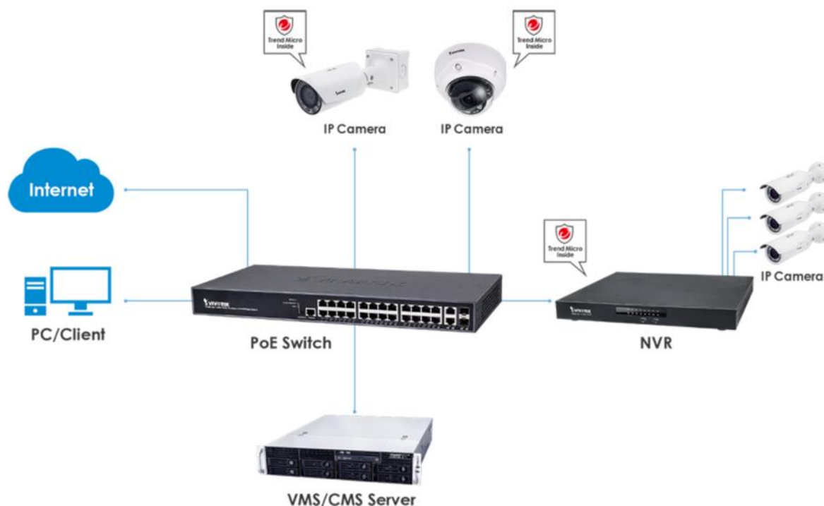
Slika 5-1 Primjer mrežnog sustava videonadzora
