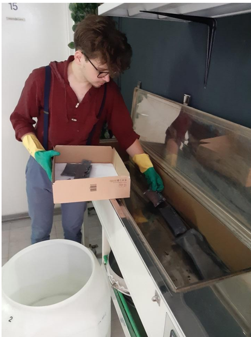
Slika 23. Postavljanje željeznih predmeta u kupku za odsoljavanje, snimila: I. Mlinarić 2021.
