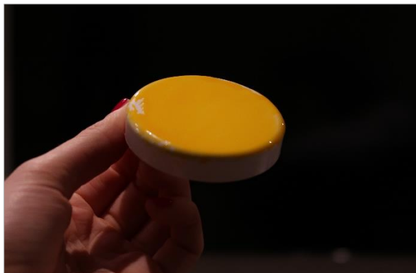
Sl. 30. Sloj žumanjka na zagrijanoj polietilenskoj podlozi
