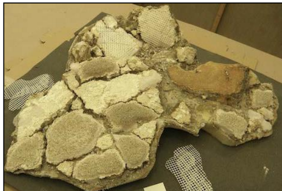
Slika 28. Komadići Dryvit staklene mrežice pričvršćeni su žbukom sastavljenom od injekcijske smjese VAP0 0/1 i punila od recikliranog stakla.
