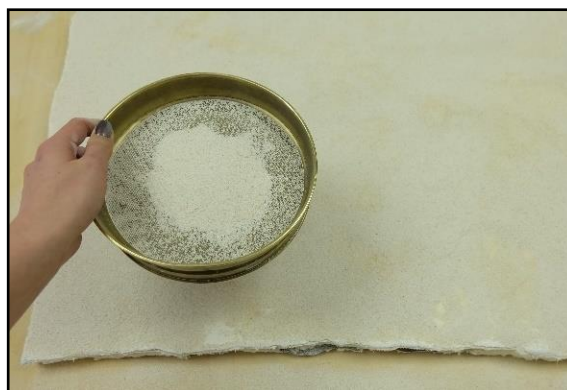
Slika 140. Sipanje vapnenačkog drobljenca na prvi (djelomično upijen, ali još uvijek mokar) sloj vapnenog kazeinata.
