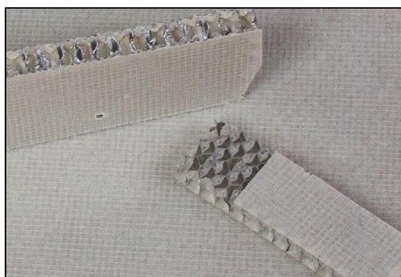
Slika 15. Alustep 500 light sendvič ploča s aluminijском jezgrom i vanjskom oplatom od impregnirane stakloplastike.
