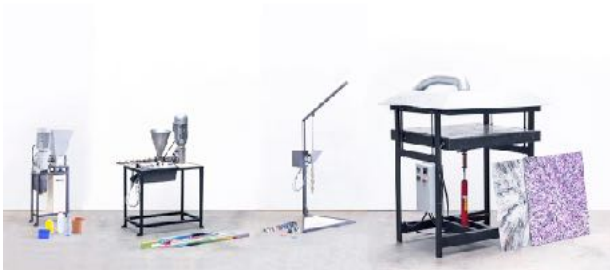
Sl. 8. Fotografija mašina izrađenih u Precious Plastic radioni
