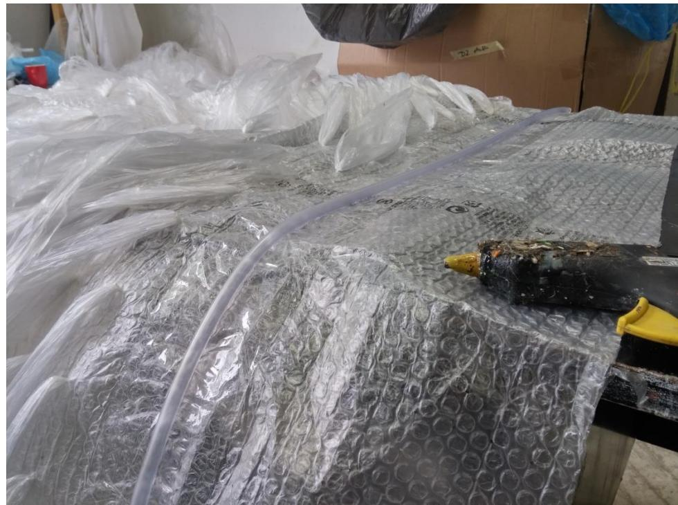
Fotografija 24: Prozirna gumena cijev zalijepljena za *plahtu* ojačanu prozirnom ljepljivom trakom
