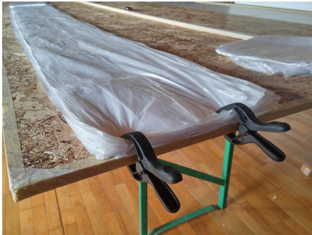
Fotografija 14: Slojevi traka spremnih za rezanje
