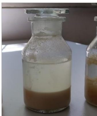
Sl. 32. Močenje kazeina u destiliranoj vodi
