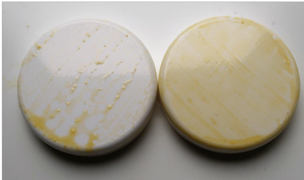
Sl. 31. Sloj cijelog jajeta nanešen na podloge; lijevo: jaje nanešeno na hladnu podlogu – skupljanje veziva, desno: jaje nanešeno na toplu podlogu – postignuta veća ravnomjernost
