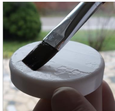
Sl. 27. Nanošenje otopine arapske gume na zagrijane polietilenske podloge
