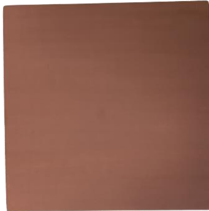
Slika 189. Testna pločica nakon nanesenog sloja crvenog polimenta, fotografirala Hana Knežević 2020.
