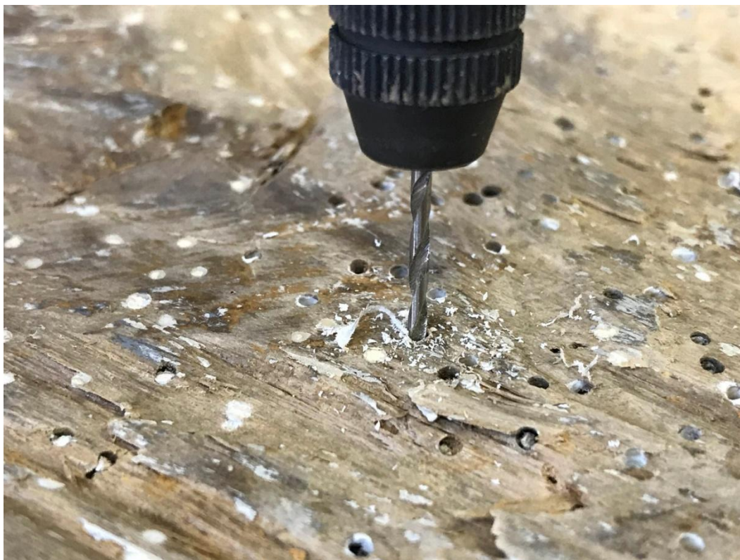
Slika 111. Uklanjanje kita iz rupica u nosiocu mehaničkim načinom pomoću svrdla, u tijeku radova, detalj, fotografirala Ana Božičević, 2019.
