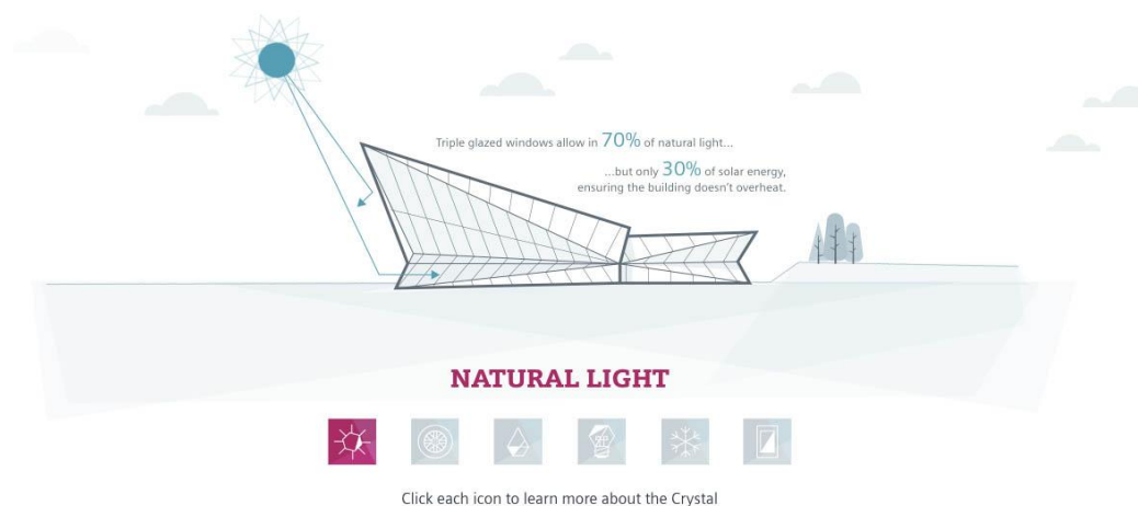
Slika 14. Infografika zgrade The Crystal u Londonu, prikaz ponašanja objekta tijekom izloženosti prirodnom svjetlu, suncu
