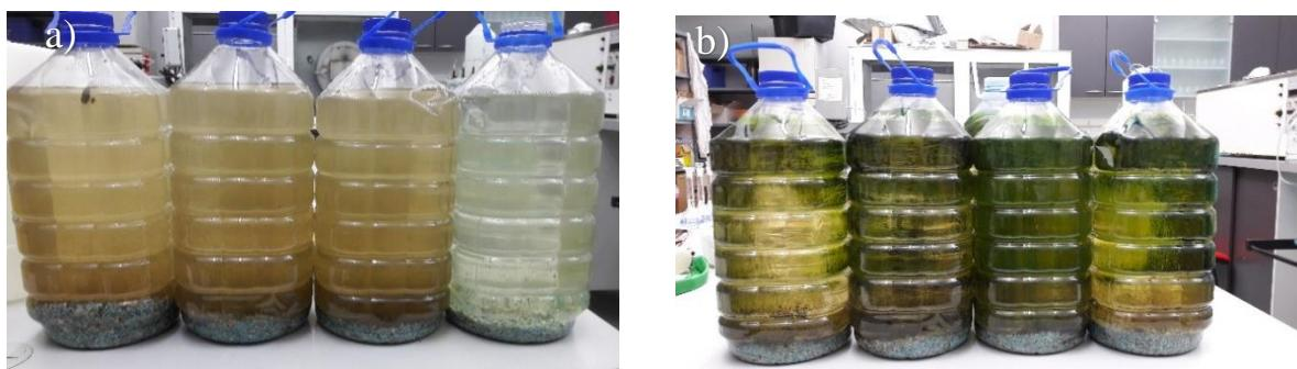
Slika 5. Akvariji za uzgoj cijanobakterija a) početak uzgoja i b) prije filtracije izvor: autor
