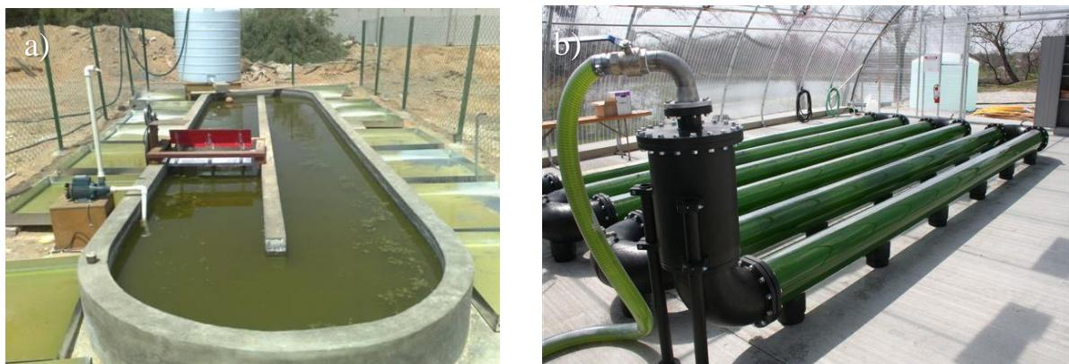
Slika 3. Prikaz a) Otvoreni i b) zatvoreni bioreaktorski sustav za uzgoj alga izvor: (Web 2)
