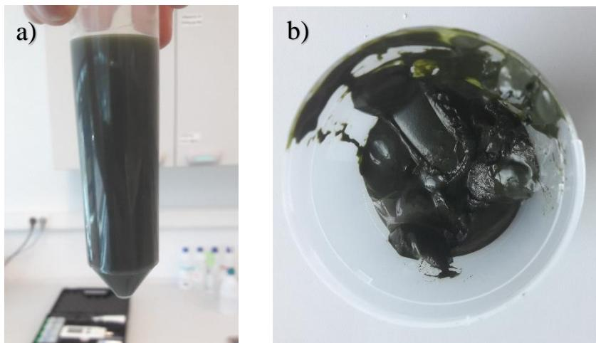
Slika 6. Pripremanje uzorka mikroalga za anaerobnu fermentaciju a) prije centrifugiranja i b) nakon centrifugiranja izvor: autor
