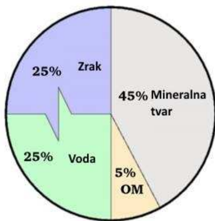
Slika 1. Komponente tla: mineralna tvar, zrak, voda i organska tvar. Prikazane postotne vrijednosti vrijede za tlo u optimalnim uvjetima (prilagođeno prema web 1).
