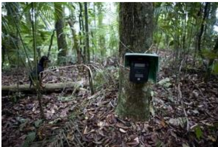
Slika 7. Primjer fotozamke korištene u istraživanju
