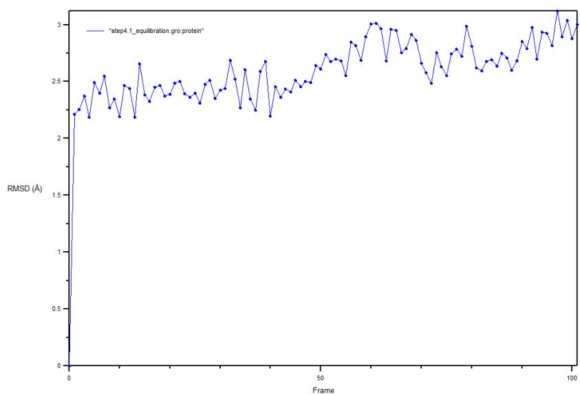
**Slika 17. RMSD dijagram za inhibitor 10.1 nakon 100 nanosekundi simulacije molekularne dinamike.** Na y-osi prikazane su RMSD vrijednosti, a na x-osi su prikazani frame-ovi.
