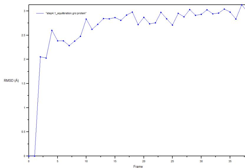
**Slika 15. RMSD dijagram za inhibitor 9.1 nakon 100 nanosekundi simulacije molekularne dinamike.** Na y-osi prikazane su RMSD vrijednosti, a na x-osi su prikazani frame-ovi.
