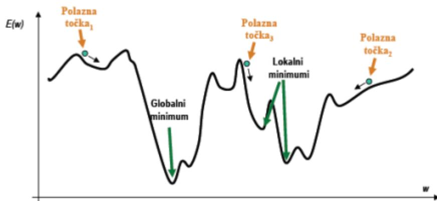
**Slika 2.2:** Grafički prikaz algoritma učenja Back propagation - lokalni i globalni minimumi
