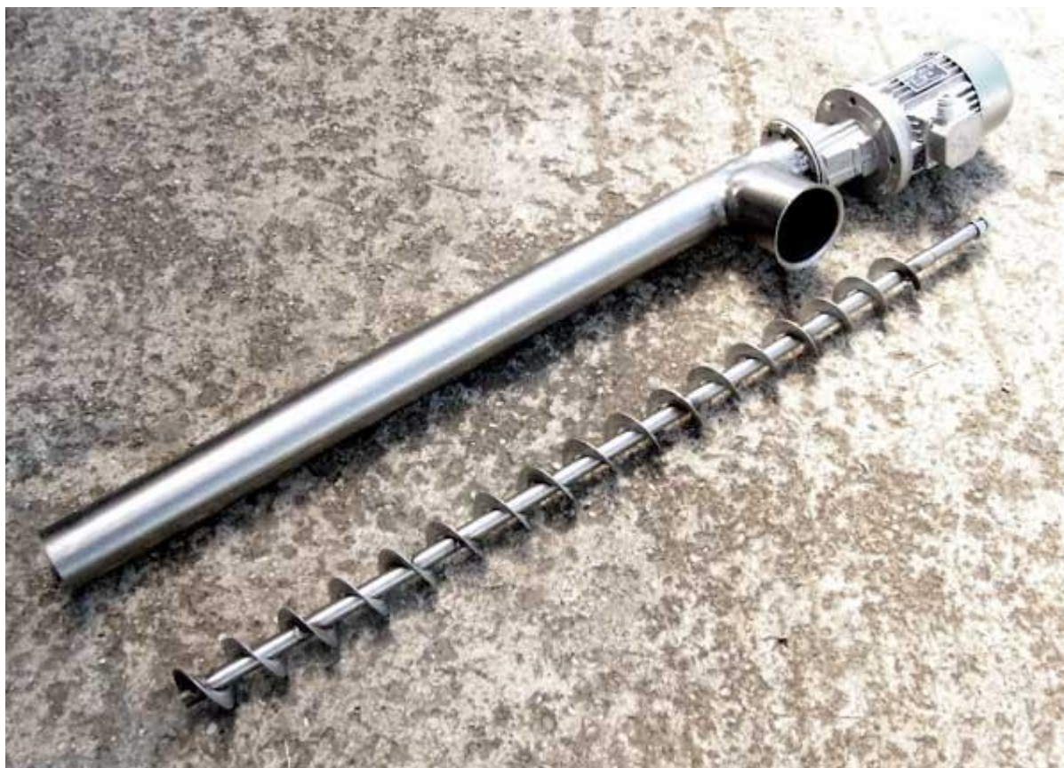
Slika 5.9. Pužni transporter [slika preuzeta s interneta]
