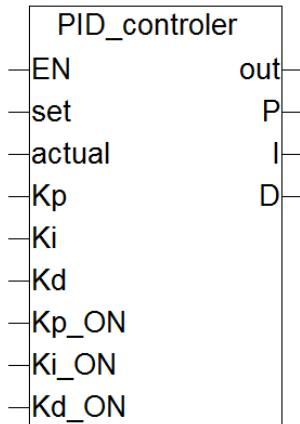
Slika 4.3. Funkcijski blok PID regulatora.
