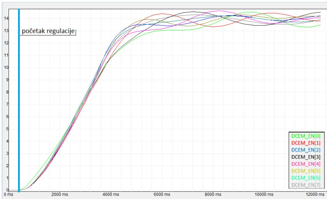
*Slika 5.6. Struje DC elektromagneta.*
