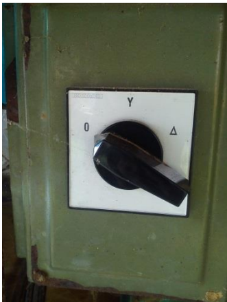
Slika 3.7. Preklopka zvijezda-trokut u pogonu
