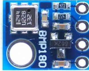
Sl. 4.5. Senzor za praćenje tlaka zraka BMP180.
