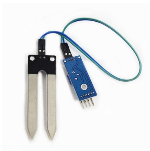
Sl. 4.7. Senzor za praćenje vlage zemlje LM393.
