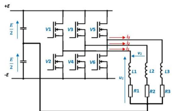
Slika 4.8. Trofazni izmjenjivač u polumosnom spoju [4]
