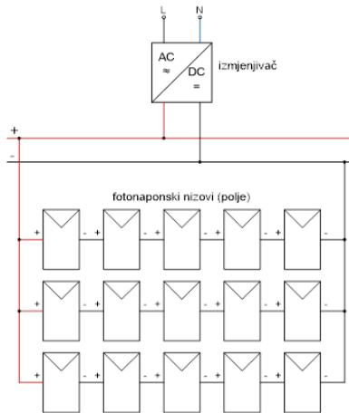
**Slika 2.16.**Mrežna FN elektrana s jednim izmjenjivačem [2]
