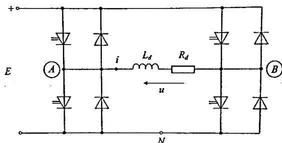
Slika 4.4. Jednofazni izmjenjivač u mosnom spoju [3]
