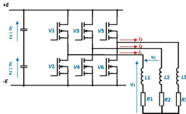
Slika 4.7. Trofazni izmjenjivač u mosnom spoju [4]
