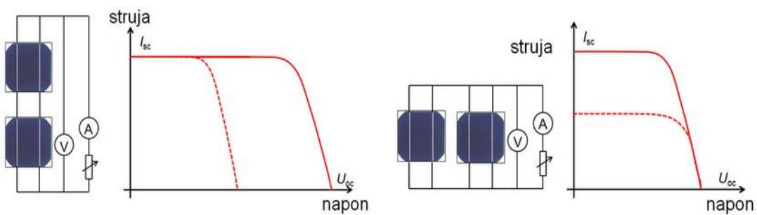
Slika 2.7. Rezultat serijskog i paralelnog povezivanja modula [11]
