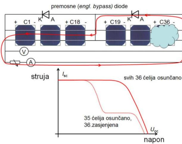
Slika 2.14. Smanjenje utjecaja zasjenjenja modula na U-I karakteristiku pomoći bypass diode [11]
