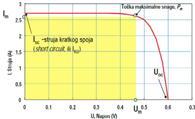
Slika 2.6. Strujno-naponska karakteristika fotonaponske celije [10]
