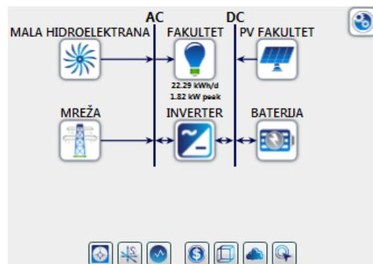
**Slika 6.20.**Shema sustava nakon dodavanja male hidroelektrane
