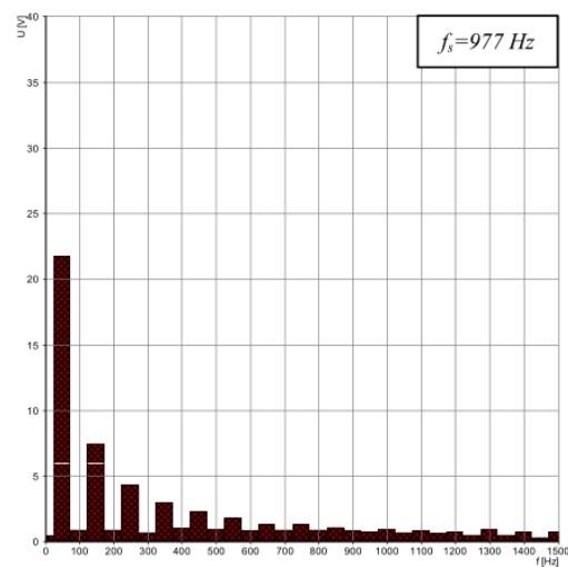
Slika 4.13. Spektralna analiza trofaznog izmjenjivača u polumosnom spoju [4]
