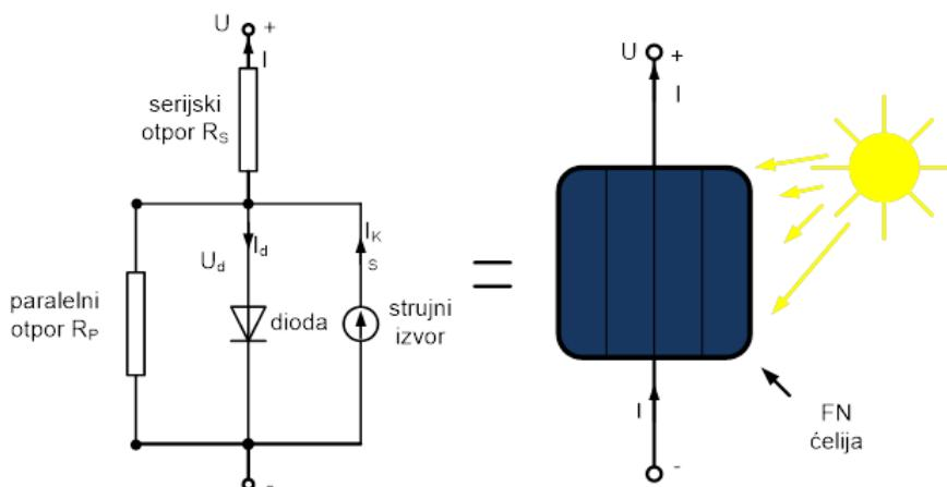
Slika 2.5. Nadomjesna shema fotonaponske ćelije [10]
