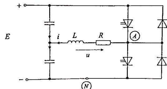
Slika 4.5. Izmjenjivač u polumosnom spoju [3]
