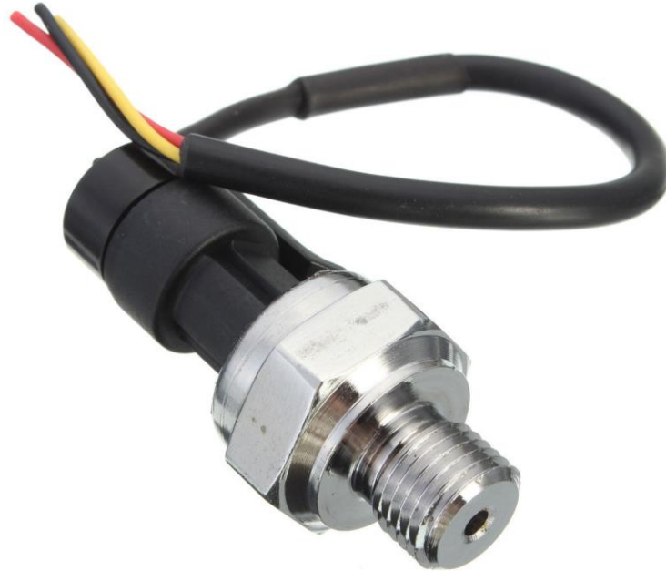
Slika 3.13: Analogni senzor pritiska.
