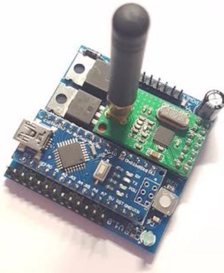
Slika 3.34: Izgled izvršne jedinice nakon sastavljanja na tiskanoj pločici.
