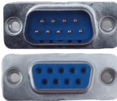
Slika 2.1: Konektor SUB -D9 za spajanje uređaja na CAN sabirnicu.
