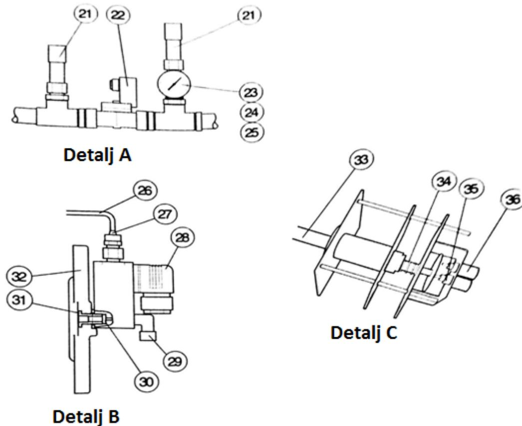
Slika 3.35. Odmrzivač zraka, detalji „A“, „B“ i „C“ [3]
