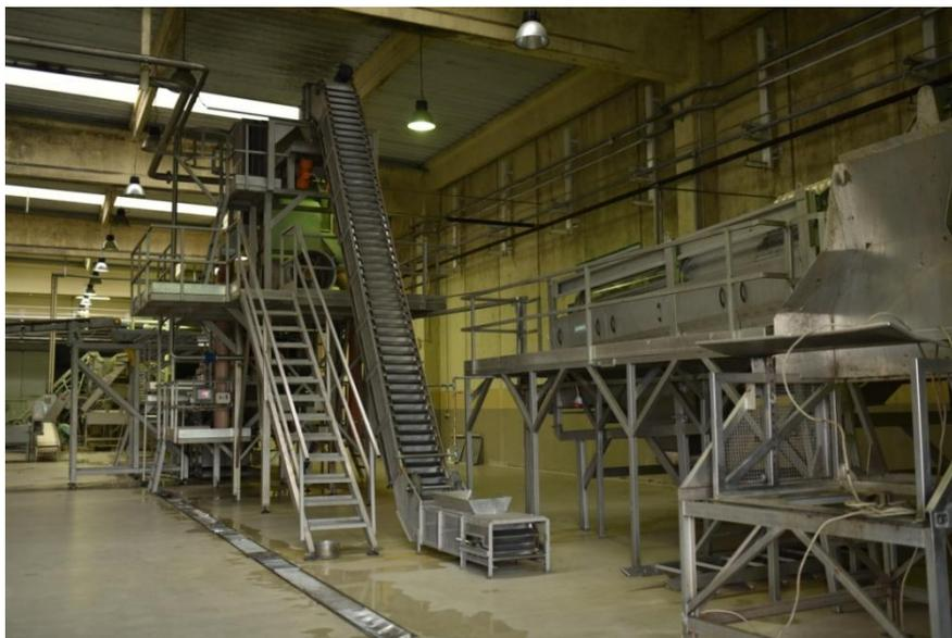
**Slika 3.6.** Spoj transportera i rotacijskog stroja za čišćenje [1]
