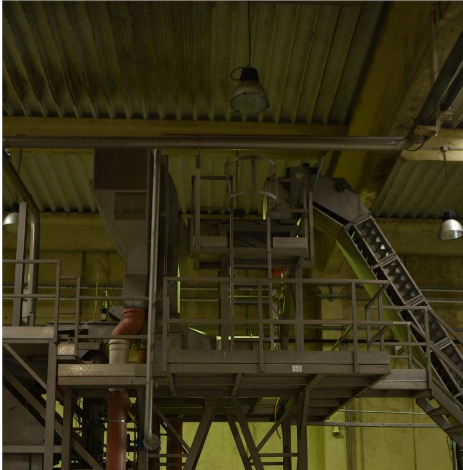
*Slika 3.9. Spajanje zračnog separatora i transportera sa strugačima [1]*
