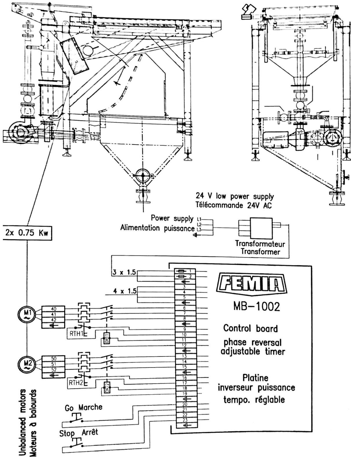
Slika 3.14. Spajanje vibracijskih motora na kontrolni panel [3]
