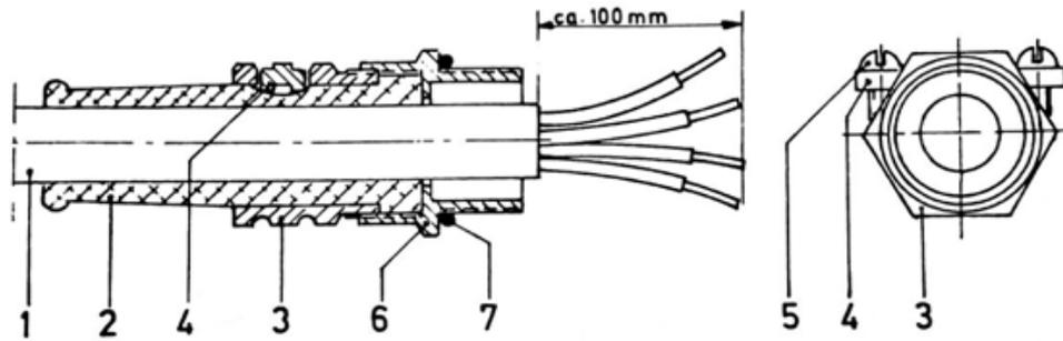
Slika 3.19. Izgled kabela za spajanje vibracijskih motora na priključnu kutiju [3]
