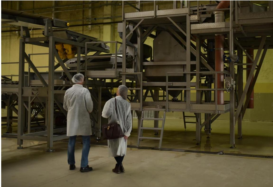
*Slika 3.12. Hidraulični odvajač kamena [1]*
