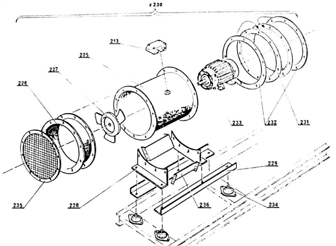
Slika 3.10. Zračni separator [3]
