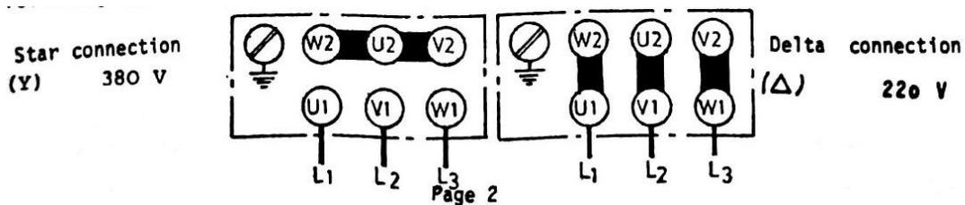
Slika 3.20. Spajanje na trofazni izvor napajanja pomoću zvijezda i trokut spoja [3]
