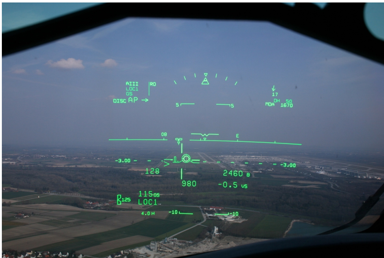
Sl. 2.1. Prikaz HUD-a u zrakoplovu [9]
