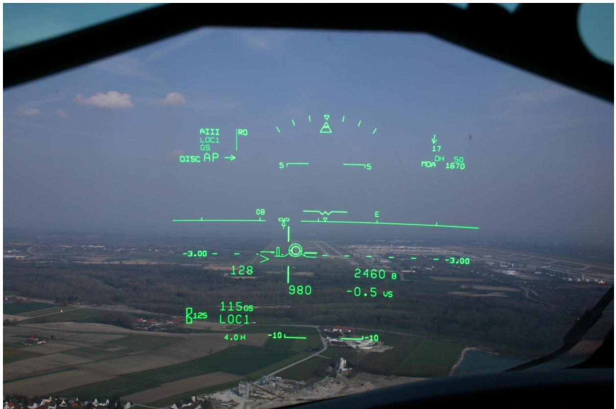
Sl. 2.1. Prikaz HUD-a u zrakoplovu [9]
