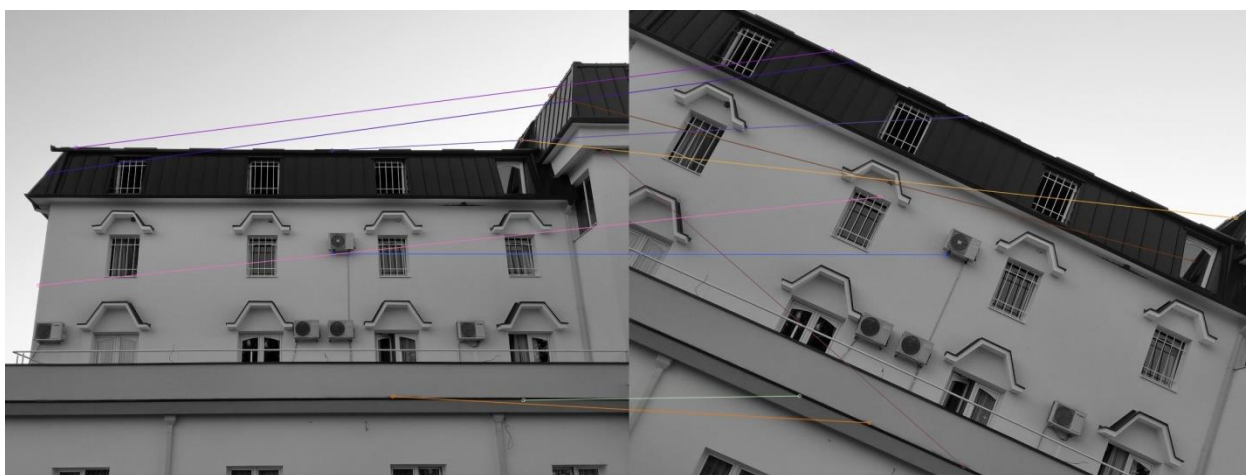
Slika 4.8. Rezultat FREAK algoritma
