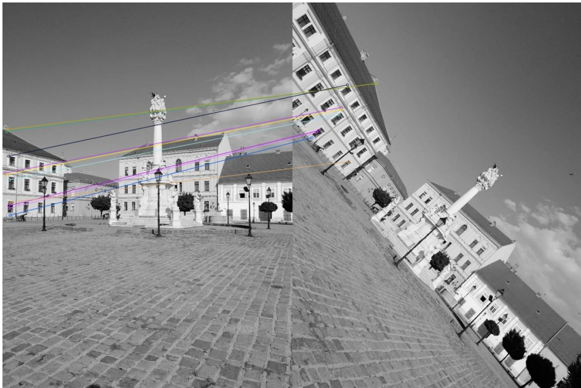
Slika 4.14. Rezultat SIFT algoritma
