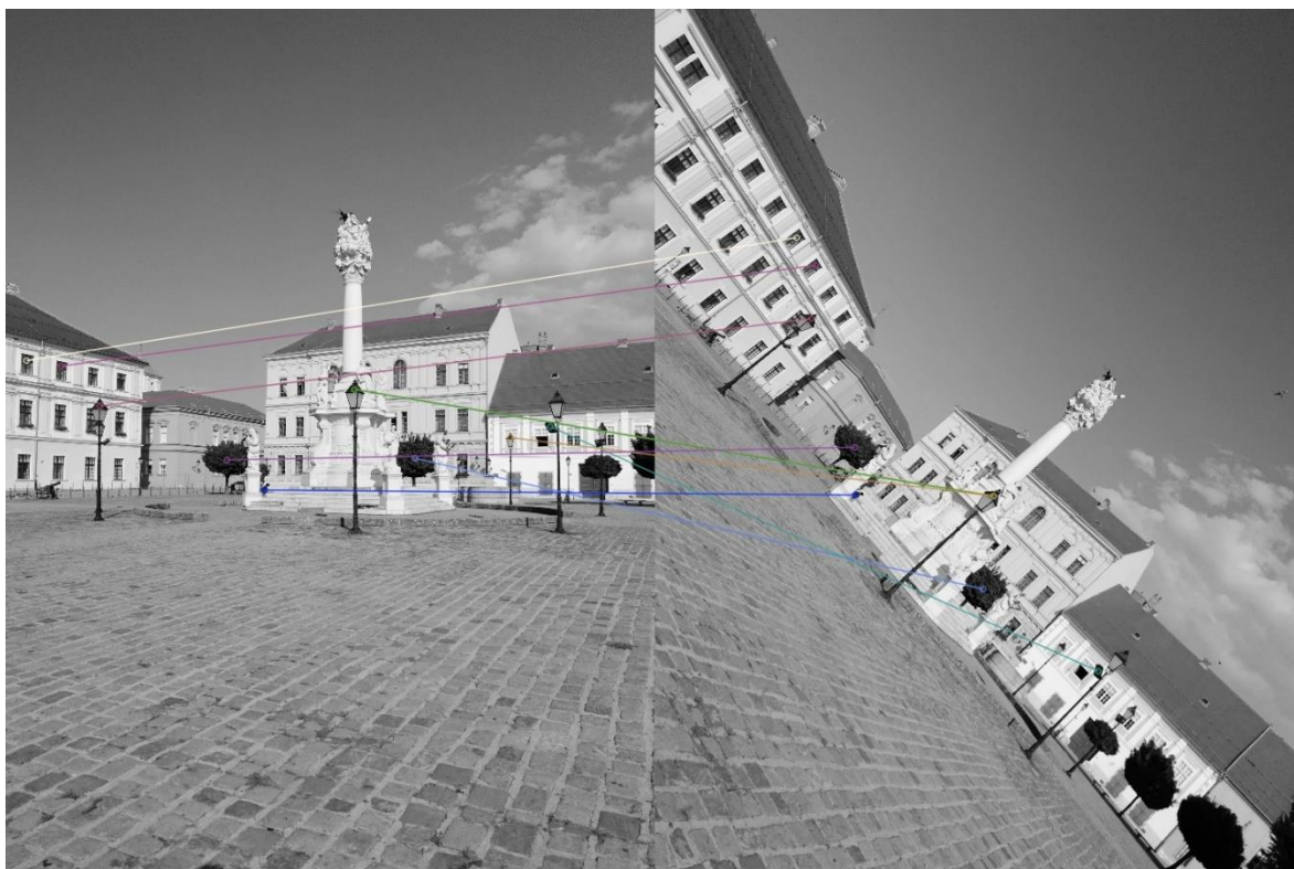
Slika 4.15. Rezultat SURF algoritma
