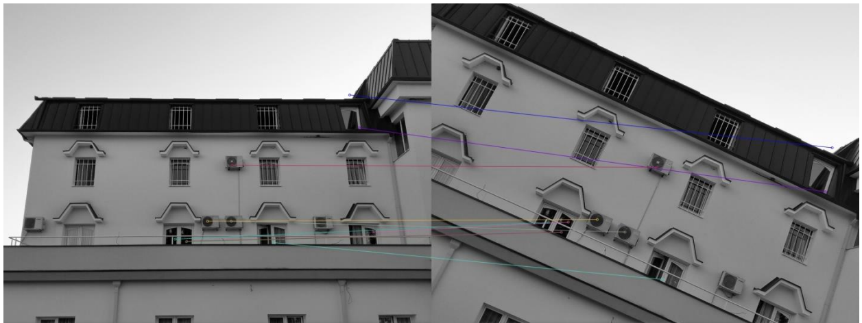
Slika 4.10. Rezultat SURF algoritma
