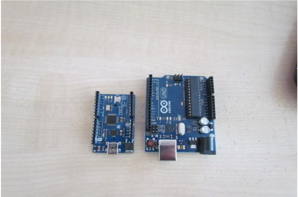
Slika 11 Lijevo: Croduino Basic2; Desno: Arduino Uno
