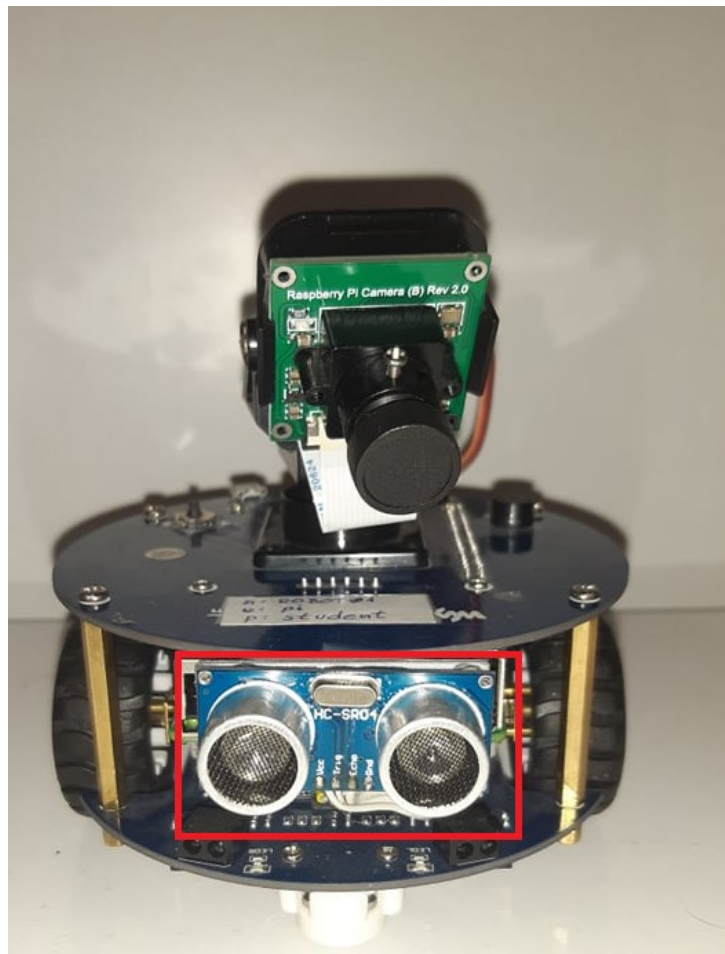
Slika 2.5 Položaj senzora na mobilnoj platformi
