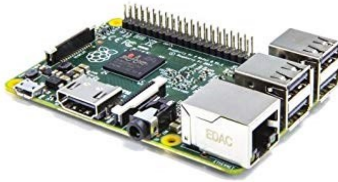
Slika 2.2 Raspberry PI 3 model B računalo
