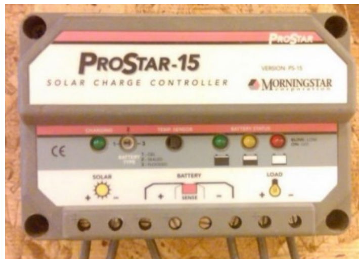
Slika 3.7. Regulator punjenja u fotonaponskom sustavu [11]
