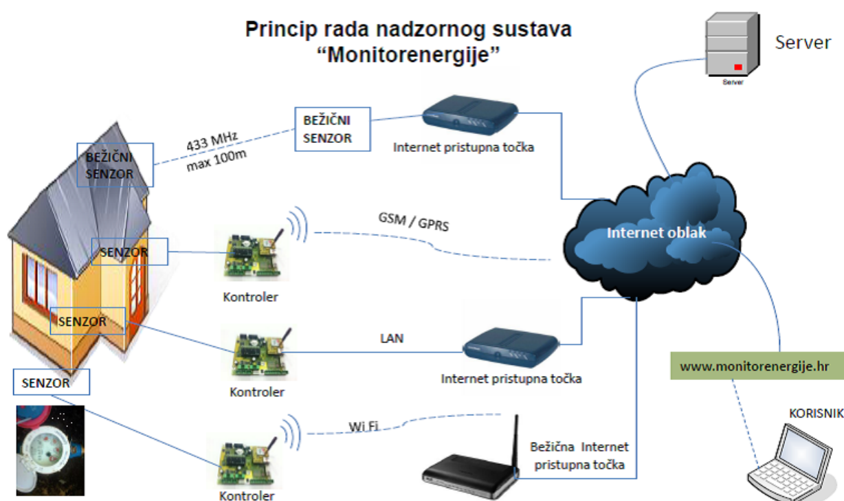
Slika 3.5. Princip rada nadzornog sustava Monitorenergije [30]
