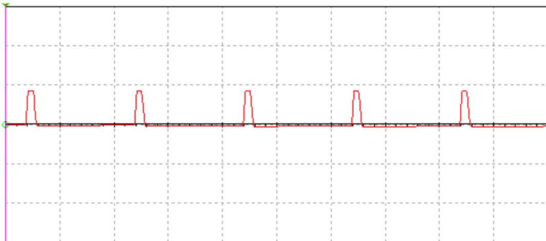
Sl. 4.15. Strujni valni oblik kolektorske struje I_C za sinusnu pobudu amplitude 20 V (pojačalo sa sinkroniziranim radom).
