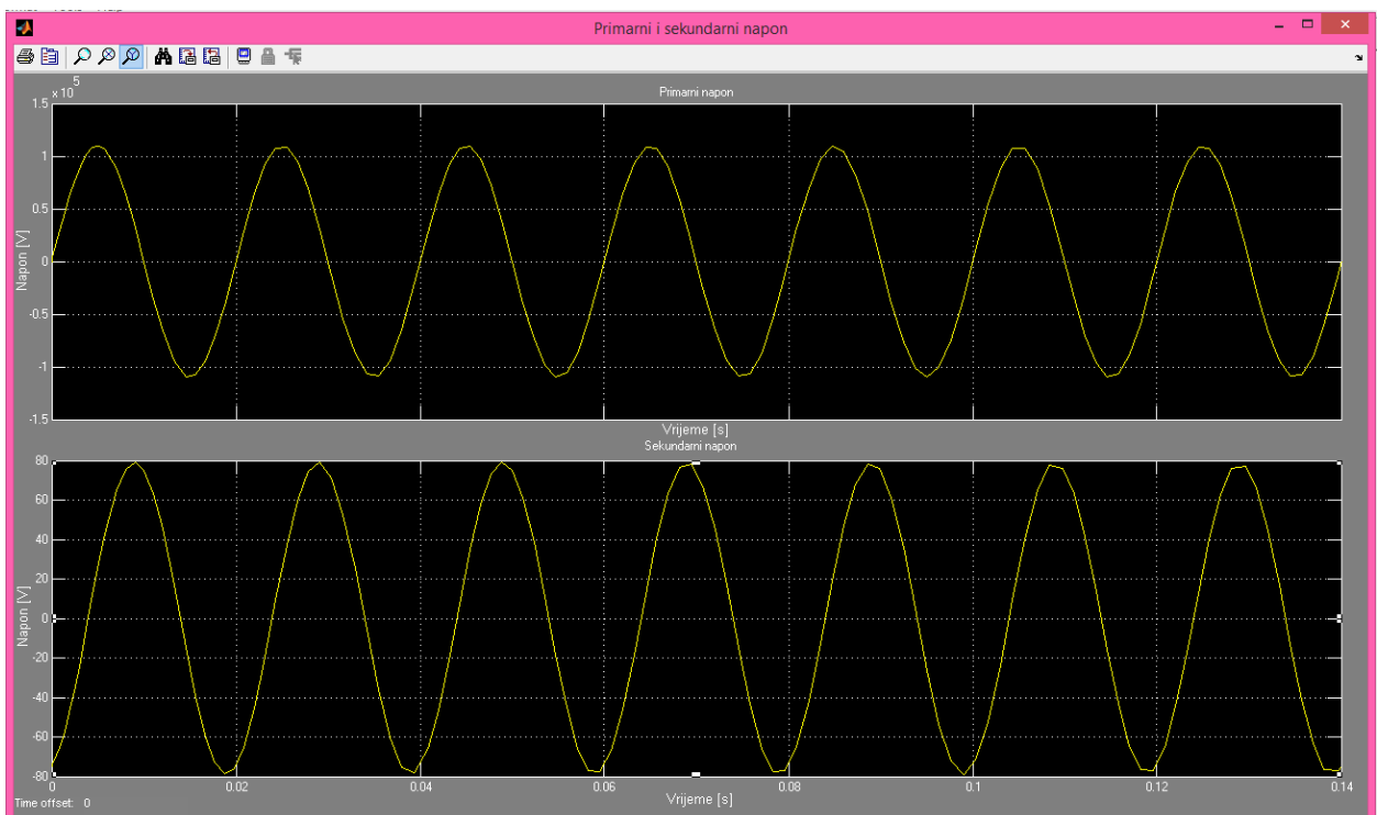
Slika 4.7. Primarni i sekundarni napon za R trošilo
