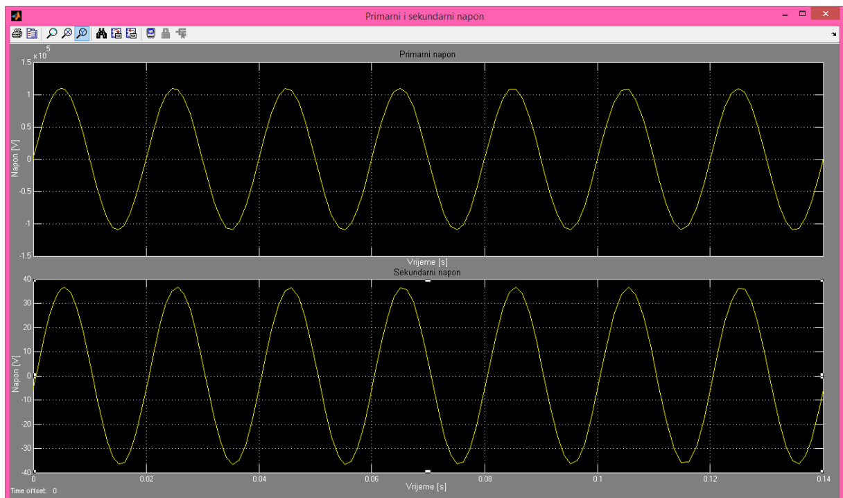
Slika 4.3. Primarni i sekundarni napon za RL trošilo
