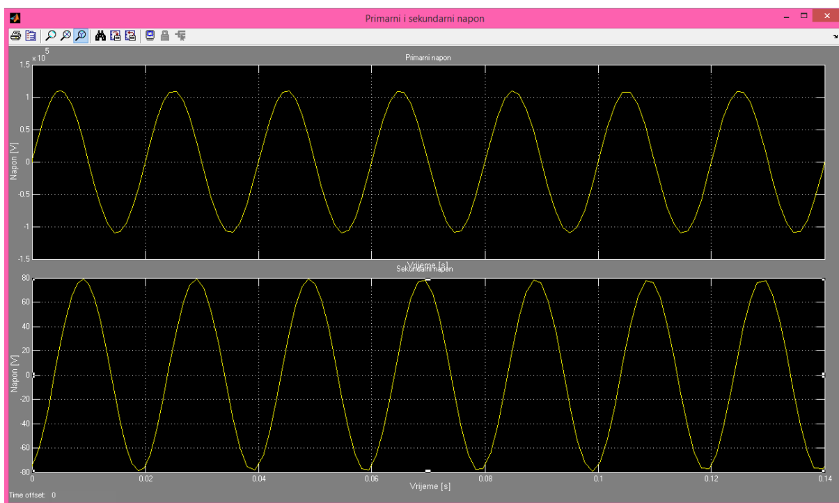
Slika 4.5. Primarni i sekundarni napon za RC trošilo
