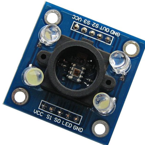
Sl. 3.8. TCS3200 mjerni član za prepoznavanje boje [10].
