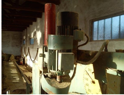
Slika 3.3. Asinkroni elektromotori u pogonu
