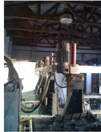
Sl. 4.7. Elektromotori za prilagodbu položaja
