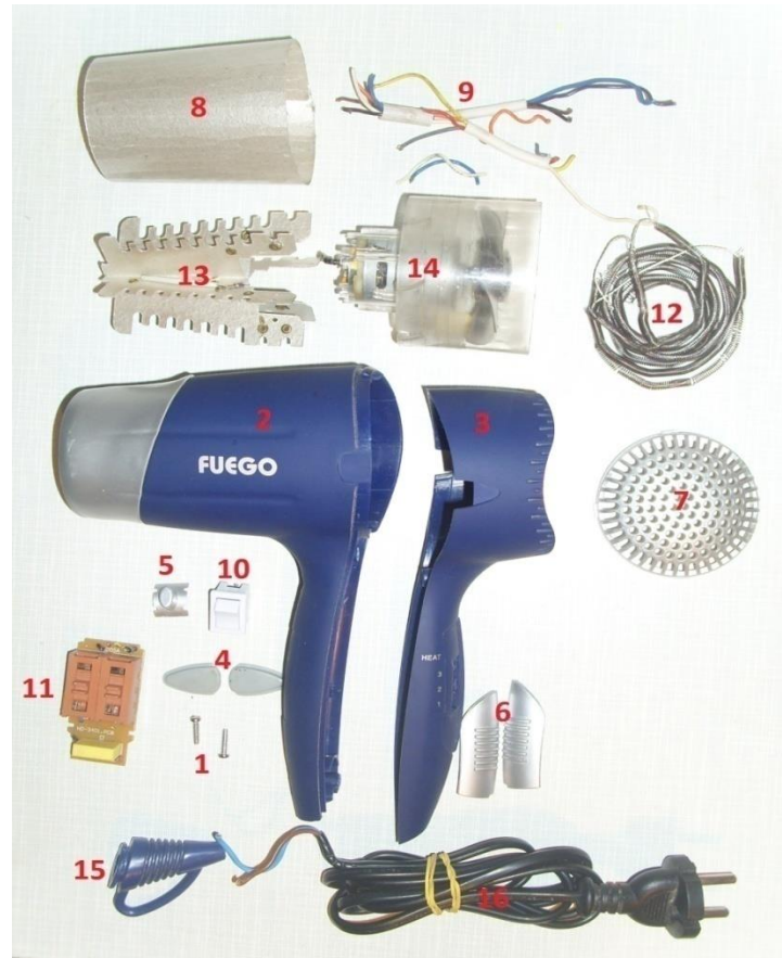
Slika 3.5. Svi dijelovi sušila za kosu
