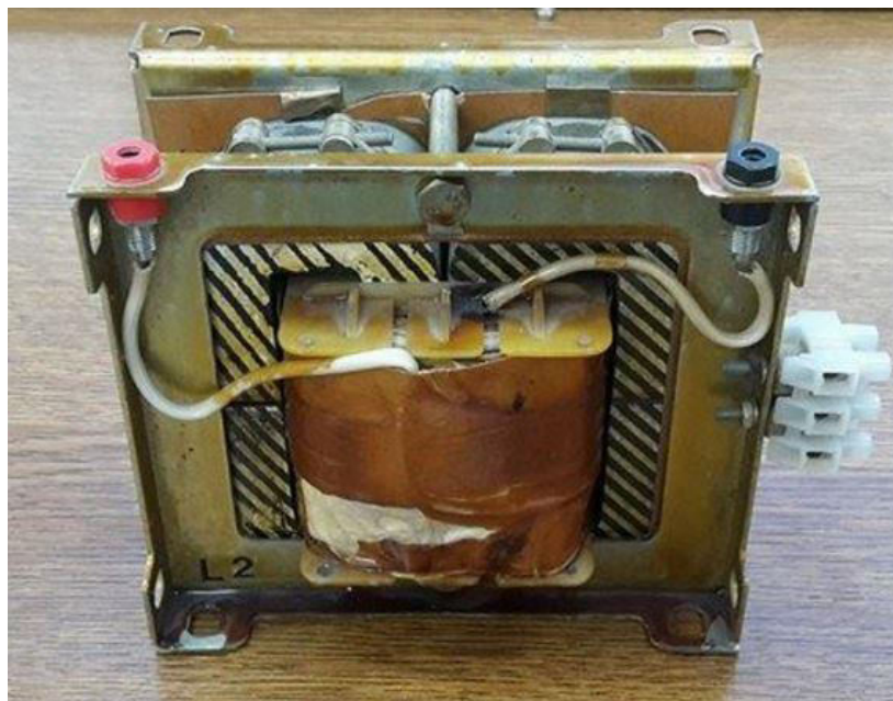
Slika 3.14. Prigušnica, R=2\Omega , L=330mH
