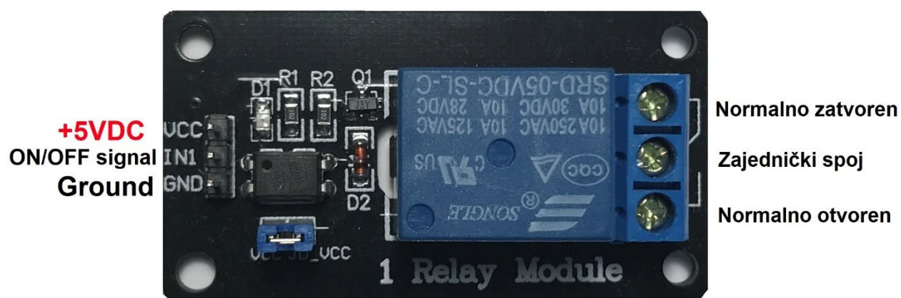
Sl. 3.12. Relejni modul sa relejnom sklopkom SRD-05VDC-SL-C
