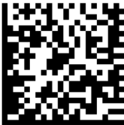
Sl. 2.7. DataMatrix kod, prema [9].
