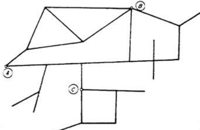
**Slika 3.4.** Zamkasta mreža s napojnim točkama A, B i C [7]
