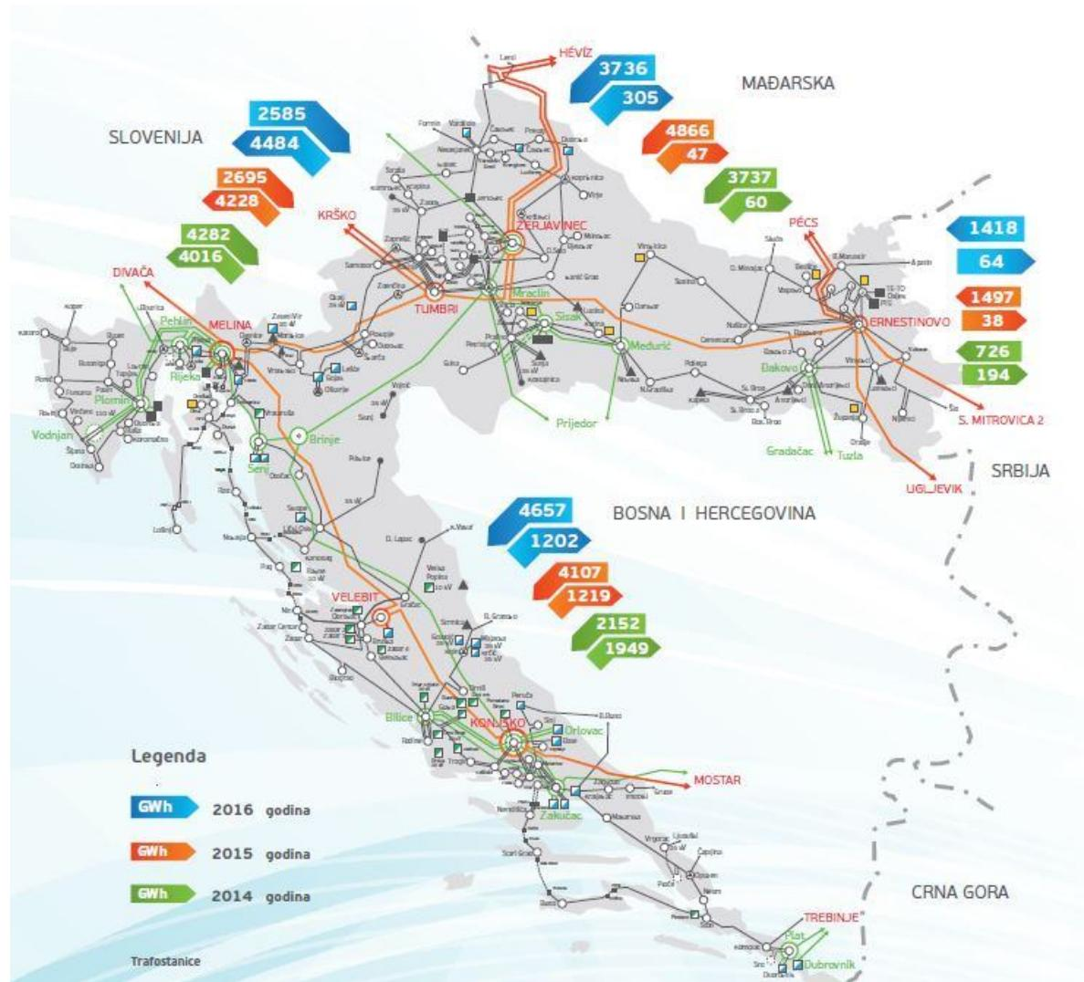
**Slika 3.8.** Shema hrvatskog elektroenergetskog sustava s razmjenom energije prema susjednim državama [8]
