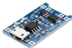
Slika 3.12. TP4056 modul za zaštitu i punjenje baterije.
