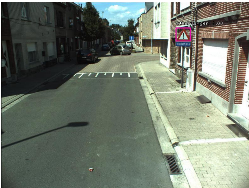
Slika 5.5. Prikaz ispravno lokaliziranih i klasificiranih prometnih znakova na primjeru prometnog znaka opasnosti na cesti (preciznost: 1,00).
