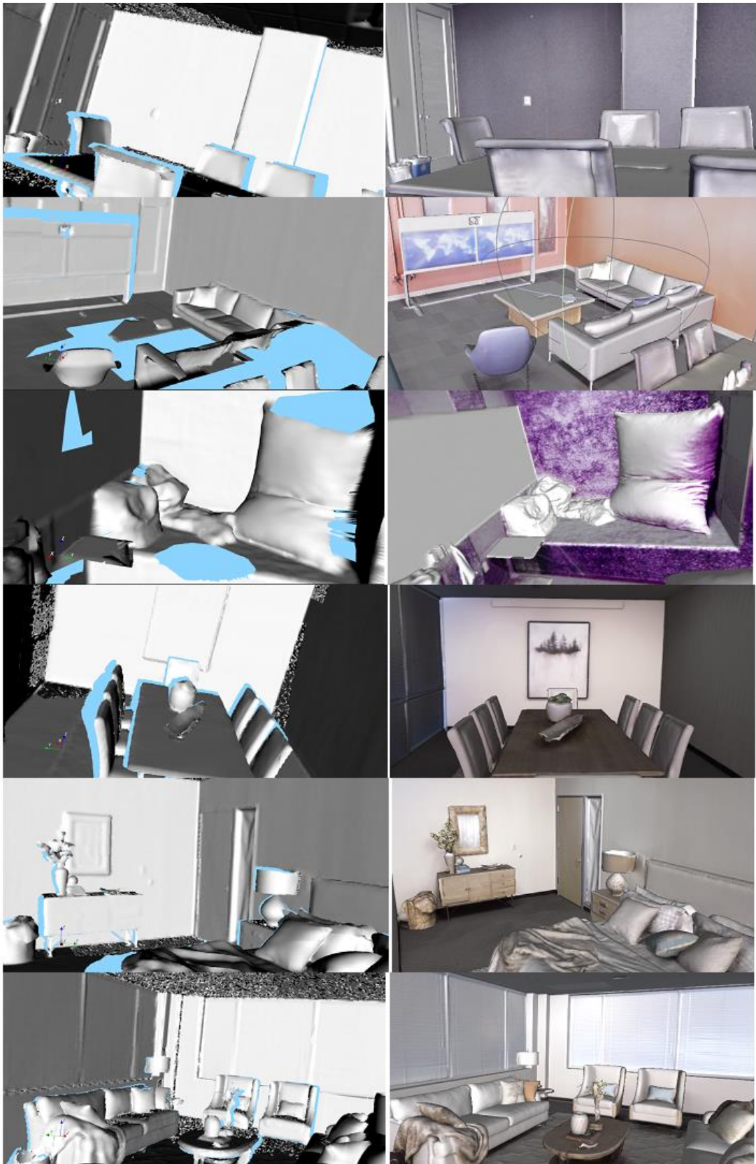
Slika 5.5 Prikaz algoritmom rekonstruirane 3D prostorije (lijevo) i odgovarajući model iz Replica baze (desno).
