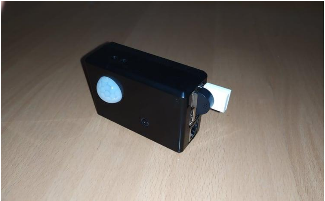
Slika 3.3. Gotova izvedba nadzornog sustava baziranog na Raspberry Pi računalu.
