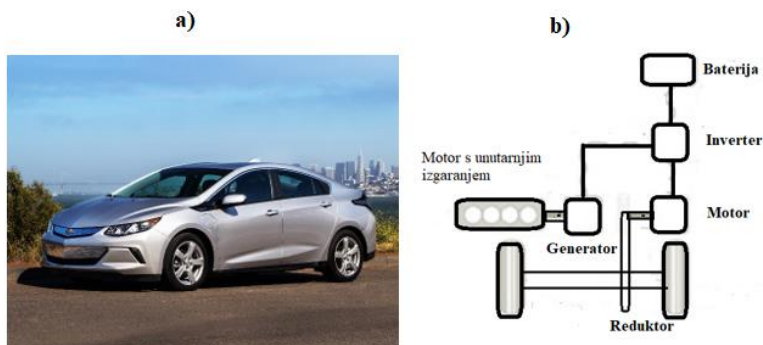
Slika 3. 4. a) Chevrolet volt - primjer serijskog hibridnog vozila, b) shema serijskog hibridnog sustava[19]
