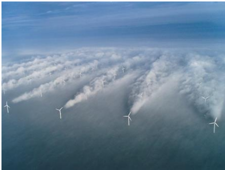
Sl. 4.12. Efekt međusobnog zaklanjanja (zavjetrine) [21]
